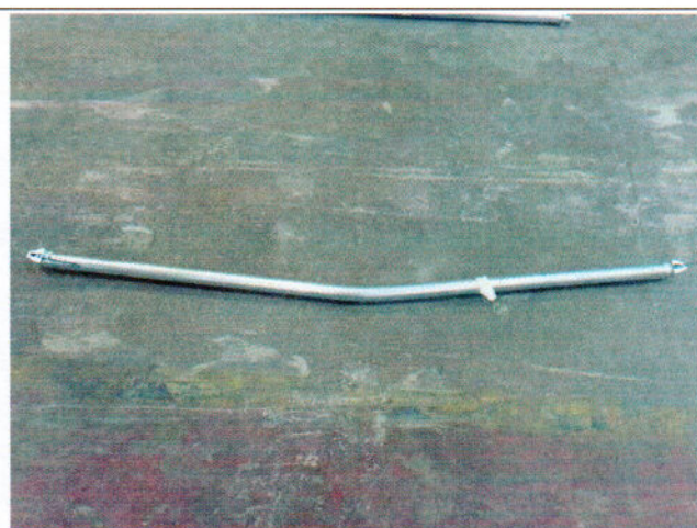
Fotografía 7.1.2.2: Plastificación probeta FB-RDB207-01
