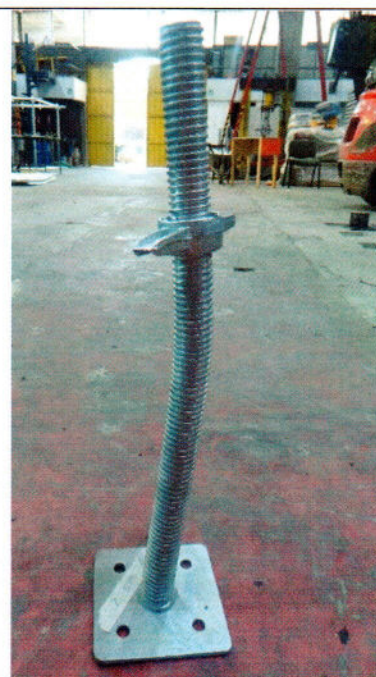
Fotografía 7.3.2.4: Plastificación probeta EBR-CSJB-02
