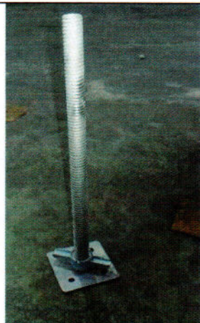
Fotografía 6.5: Vista General de base regulable con nivelador en su altura en su posición mínima.
