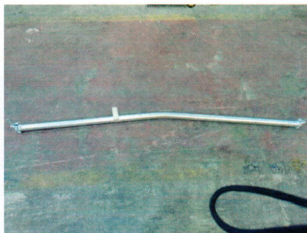
Fotografía 7.1.2.6: Plastificación probeta FB-RDB207-03
