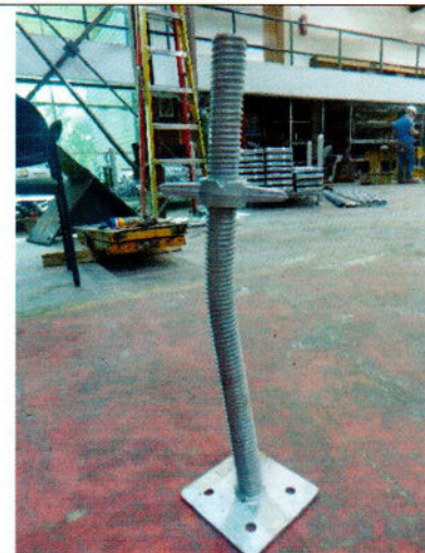
Fotografía 7.3.2.2: Plastificación probeta EBR-CSJB-01
