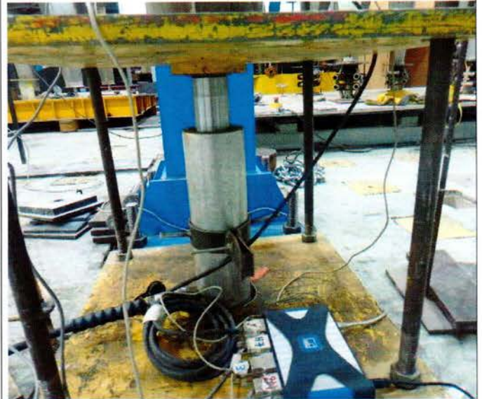
Fotografía 7.2.1.2: Detalle del apoyo del gato hidráulico
